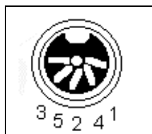
5 PIN locking DIN connector (180 deg)
